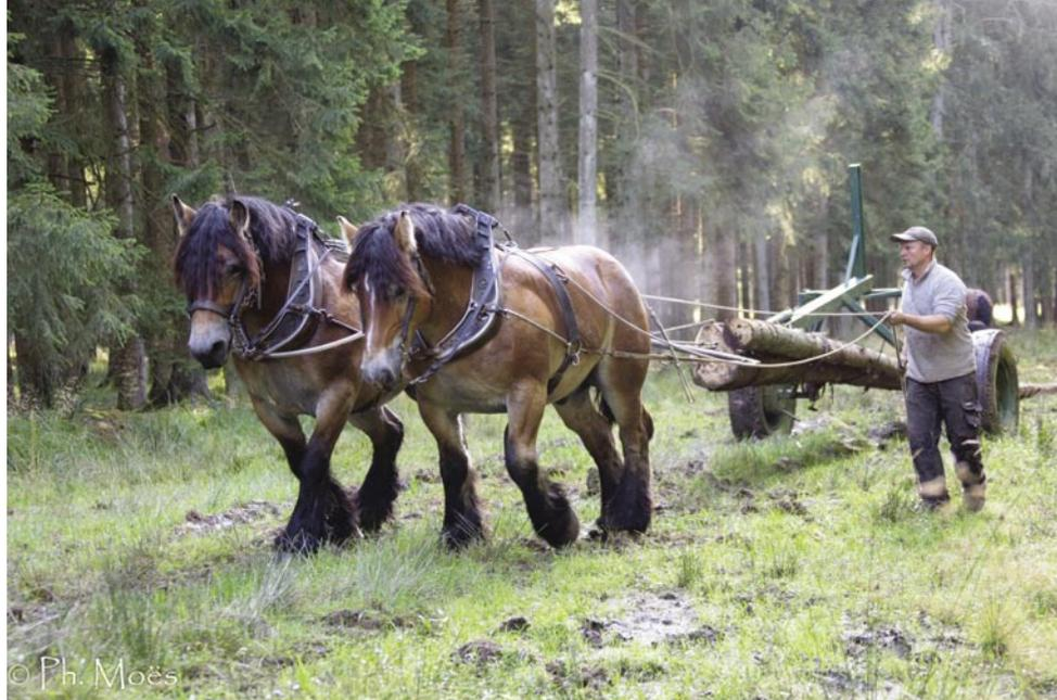
Figure 10 – Fardier ou triqueballe : dispositif muni de deux roues, permettant de soulever et porter l'avant de la charge disposée derrière le cheval ou les chevaux et, ainsi, d'en augmenter la masse potentiellement mobilisable (jusqu'à 4 m<sup>3</sup>) et la distance de transport (jusqu'à 1 km).
