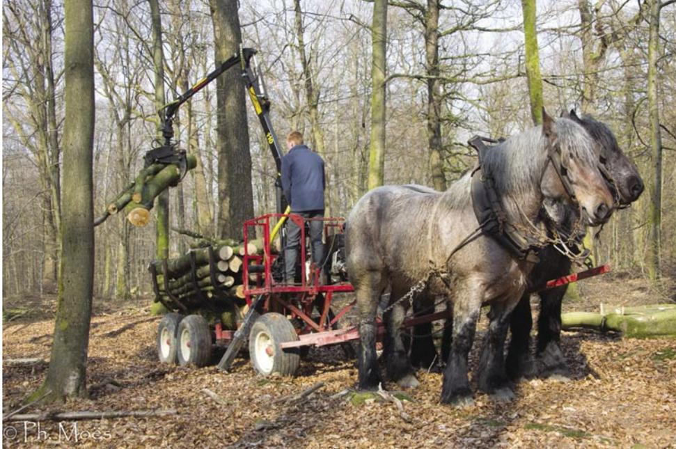
Figure 9 – Porteur hippomobile, pourvu d'un grappin de 4 mètres, servant à charger le bois sur la remorque attenante. Ce système est extrêmement respectueux du sol. Le modèle présenté ici peut supporter une charge de 4 tonnes.
